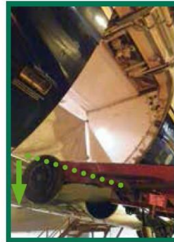
Position du beltloader pour le déchargement en dessous du seuil de soute
