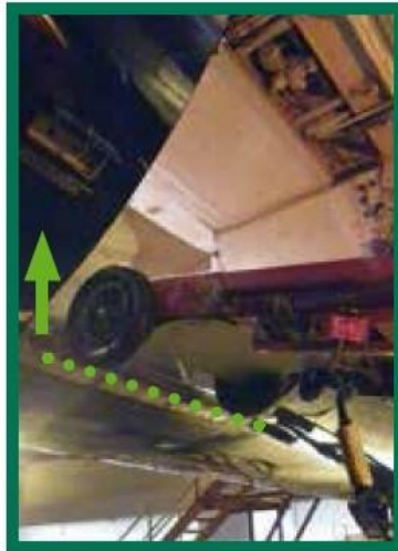
Position du beltloader pour le chargement au-dessus du seuil de soute
