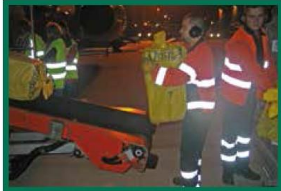
Utiliser dès que possible un beltloader pour le remplissage des soutes inférieures (belly)
