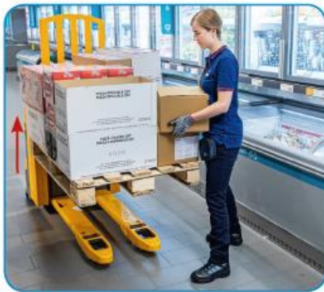
Maak optimaal gebruik van de in de hoogte verstelbare transpalet en spaar je rug.
