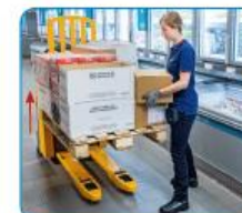
Maak optimaal gebruik van de in de hoogte verstelbare transpalet en spaar je rug.
